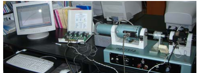
Figura 5. Fotografii ale standului de încercări a reductorului precesional cinematic.
