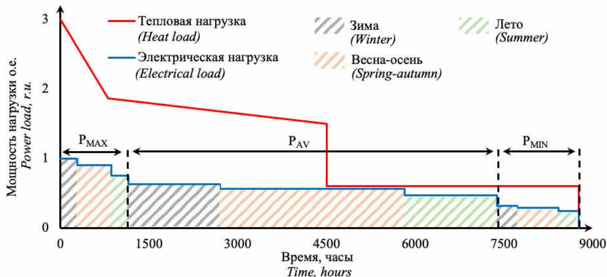
Рис. 3. Годовые графики электрической нагрузки потребителей ИСЭ.<sup>5</sup>
