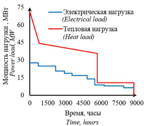
Рис.6. Годовые совмещенные графики тепловой и электрической нагрузки «СмартСити-Новосибирск».<sup>8</sup>
