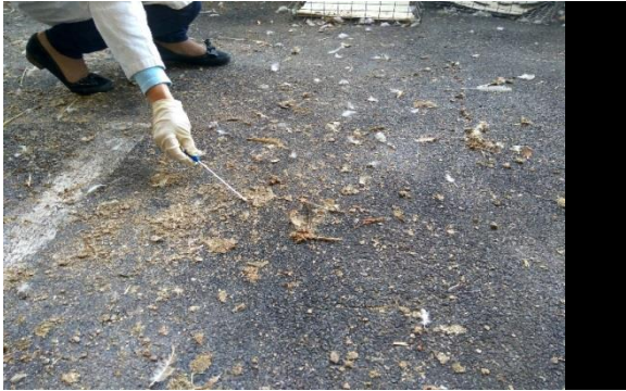
Fig. 4.11 Prelevarea lavajelor de pe pardoseală halei
