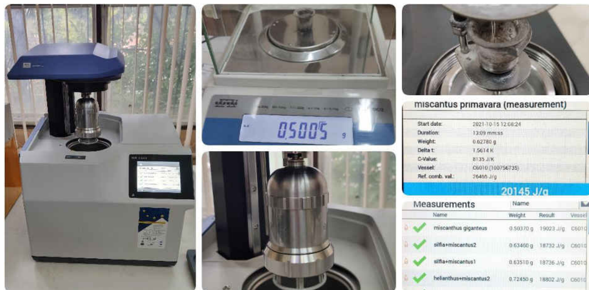
Fig. 2.6. Aspecte din timpul determinării valorii calorifice superioare la calorimetrul izoperibolic IKA C6000 în LȘBCS, UTM
