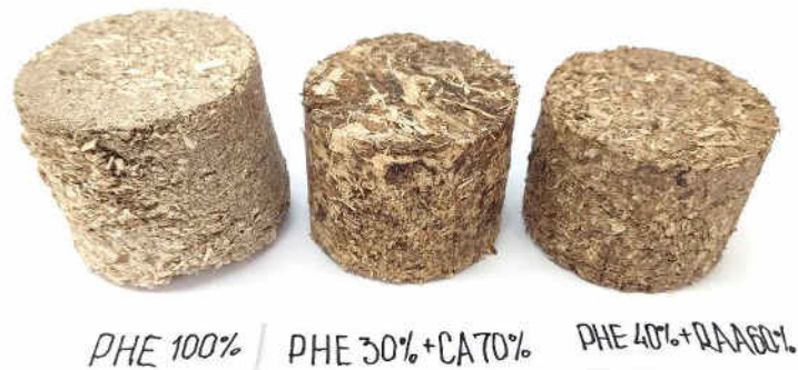
Fig. 4.10. Probe de brichete produse din amestecuri de Plop hibrid energetic (PHE) și reziduuri de cătină albă (CA) și de pomi fructiferi (RAA): PHE 100%; PHE 30%+CA70%; PHE 40+RAA 60%.
