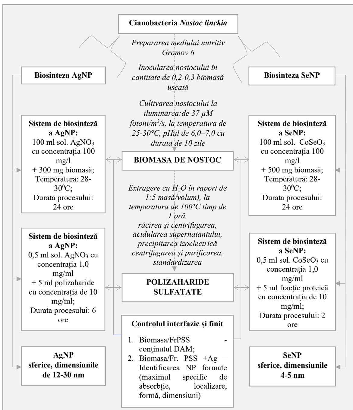
Fig. 7.11. Etapele de derulare a proceselor de biosinteză a AgNP sau a SeNP pe suport de biomasă și polizaharide din Nostoc linckia
