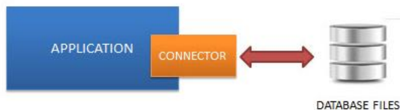
Рисунок 2. Архитектура без сервера SQLite.
