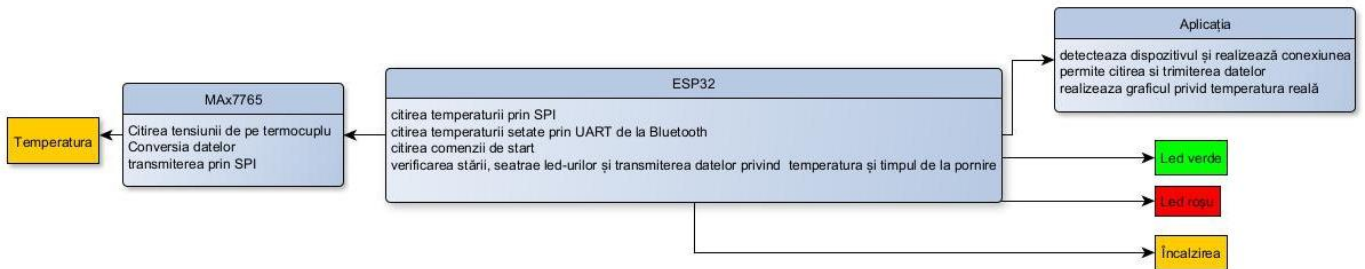
Figura 2. Schema conceptuală a dispozitivului
