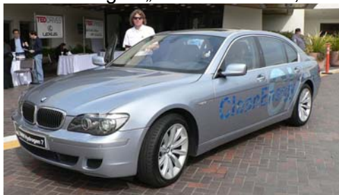
c. Automobil cu motor de combustie internă cu hidrogen BMW Hydrogen 7, 2007.
