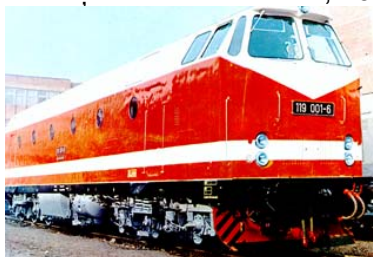
c. Locomotivă Diesel-hidraulică, Electroputere, România, 1250 cp, 1980.
