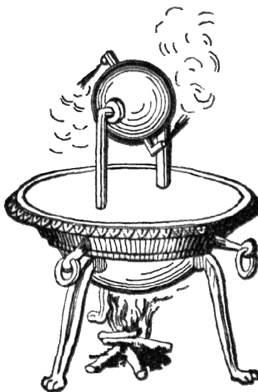
Fig. 3.4. Prima turbină cu abur cu reacțiune inventată de Heron din Alexandria.
