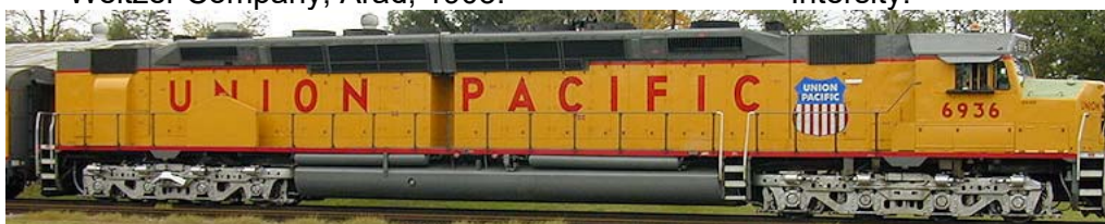
g. Locomotiva „Centennial”, cea mai puternică locomotivă Diesel-electrică din lume (6600cp, viteză – 145 km/h).
